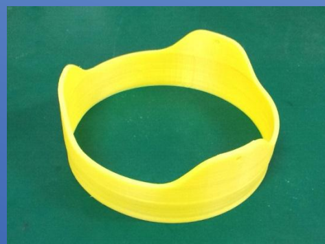
プロペラのノズルも印刷
